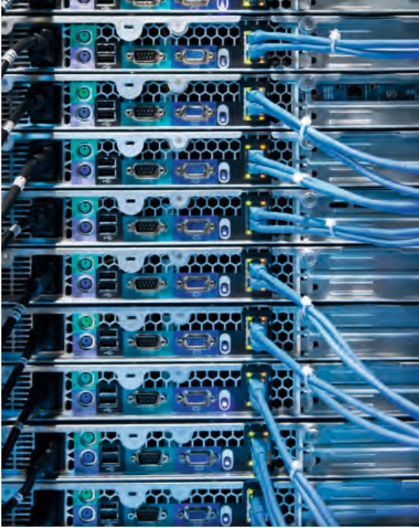
Moderne Hochleistungsdatenkabel bringen High-Speed-Internet in die Häuser. Die Ummantelung dieser Datenkabel besteht aus Ethylen und Propylen.
